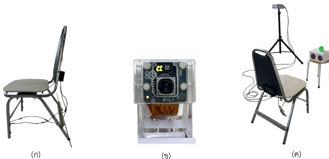
ภาพที่ 1 ระบบต้นแบบสำหรับการประเมินสมดุลท่าทางเชิงปริมาณ (ก) แก้อัปเดตที่มีการติดตั้งโหลดเซลล์ (ข) กล้อง (ค) การติดตั้งระบบเพื่อทดสอบ
